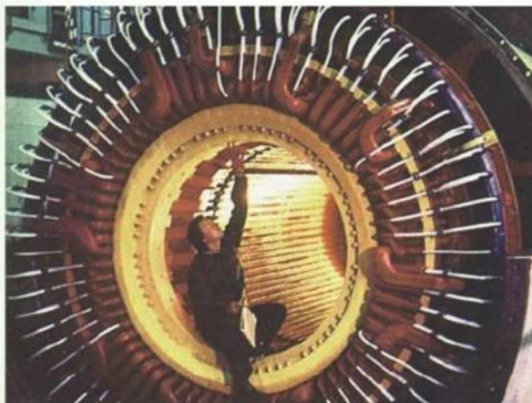
Сборка генератора на заводе «Электросила»
